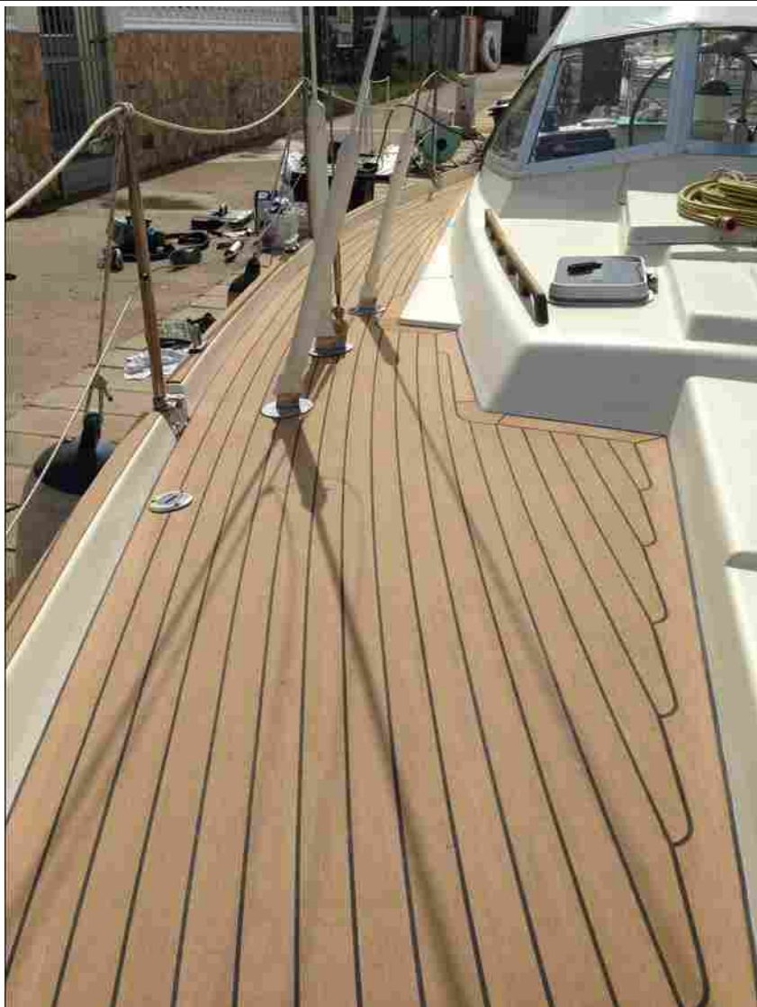
Un pavimento Permateek posato su barca
